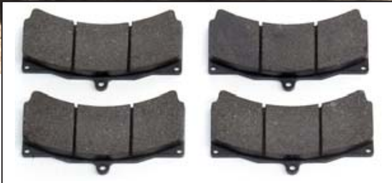
Bremsklötze Touareg Geänderter Reibwert, verwendbar für Fahrzeuge mit höherer Achslast.
