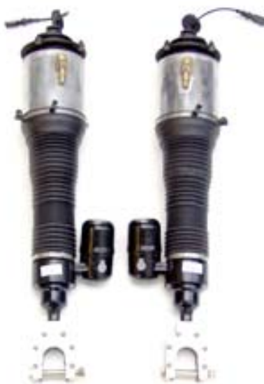
Luftfederbein Bentley Flying Spur Verstärkt in Druck- und Zugstufe. Verstärkung an der Federgabel- aufnahme unten. Für Fahrzeuge mit höherer Achslast.
