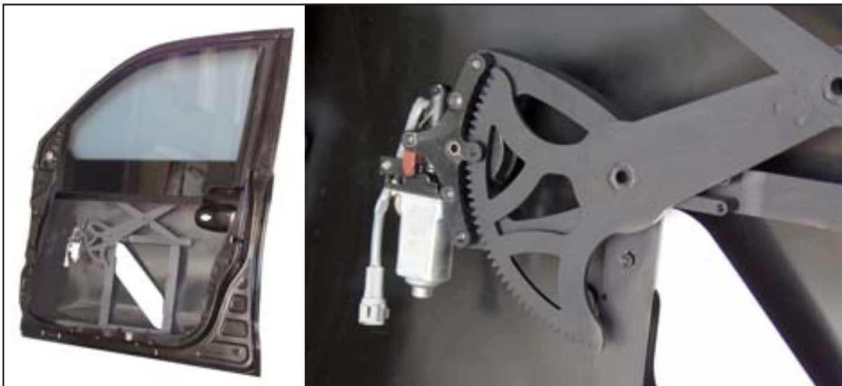
Fensterheber Land Cruiser J 200 Absenkbar bis auf 40 mm. Schalter und Motor können von Serie verwendet werden. Für Sicherheitsfahrzeuge B6 und B7.
