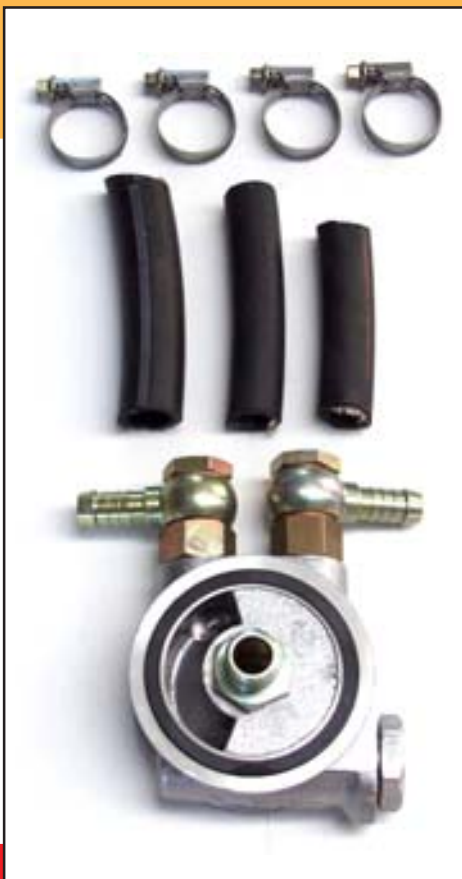
Ölkühlanlage J 100/J 105 Benzin Beim Einbau der Ölkühlanlage wird die Öltemperatur gesenkt. Einfacher Einbau. Flansch wird zwischen Ölfilter und Motorgehäuse verschraubt. GOMA 6913
