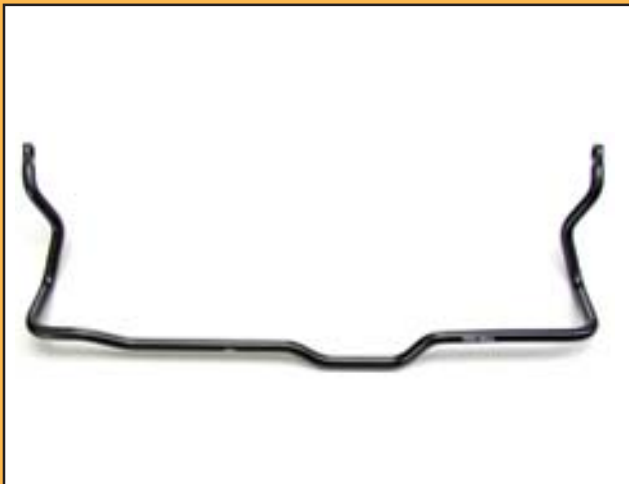
Stabilisator J 100/J 105, HA Verstärkt, um die Kurven- stabilität zu verbessern. J 100 - GOMA 6055 J 105 - GOMA 6058
