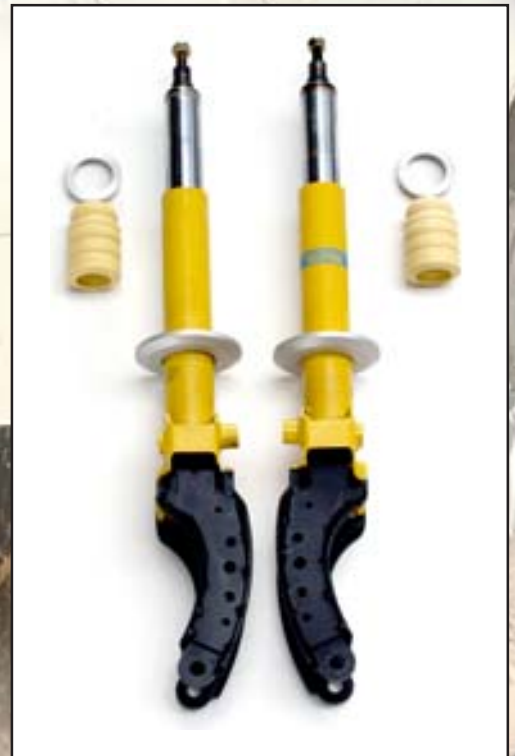
Federbein Touareg VA Verstärkt in Druck- und Zugstufe. Aufbau Federbein mit Spiralfeder. Auslegung der Feder abhängig vom Fahrzeuggewicht.
