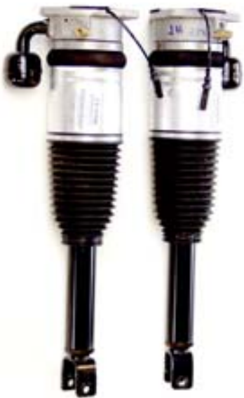
Luftfederbein Bentley Flying Spur Verstärkt in Druck- und Zugstufe. Verstärkung an der Federgabel- aufnahme unten. Für Fahrzeuge mit höherer Achslast.
