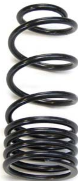
Hinterfeder Land Cruiser J9/J12 Verwendbar für Fahrzeuge mit höherer Achslast. GOMA 6198
