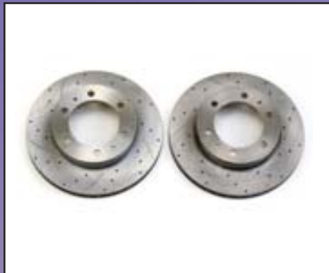
Bremsscheiben J 7 VA Gelocht und geschlitzt, zur besseren Wärmeabführung.
