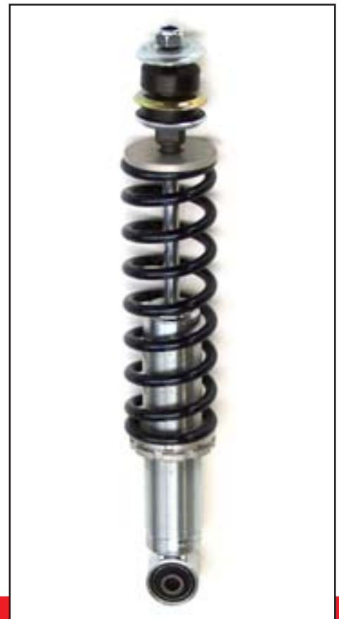
Gewindefederbein J 100, VA Verstärkt in Druck- und Zugstufe. Mit Zusatzfeder lieferbar (verschiedene Federstärken, abhängig vom Fahrzeug- gewicht).
