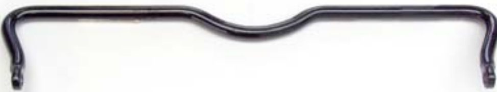
Stabilisator Mercedes G, HA Verstärkt, um die Kurvenstabilität zu verbessern.
