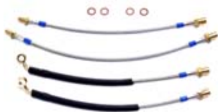
Stahlflex Bremsschläuche J 100 / J 105 Zur Erhöhung des Bremsdruckes.
